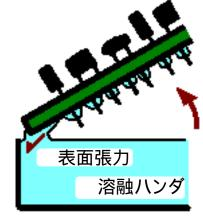
基板に斜めの角度で離脱させることにより、右図の ように余分なハンダが引っ張られ、ブリッジやつらら が発生しにくい状態を作り出します。
