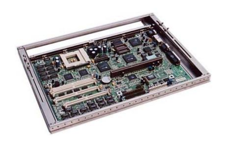
1)装置側の搬送(コンベア)幅を一定にしたままサイズの異なる基板を流す事ができるため、 段取り替えに要する作業ロスを大幅に削減
