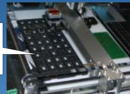
装置の奥側に配置した部品(IC)トレイ。トレイホルダー(置き台)は標準付属品として本体セットに含まれます。
