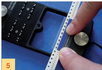
スプライステープを破線部で折り返し、よく押える。
