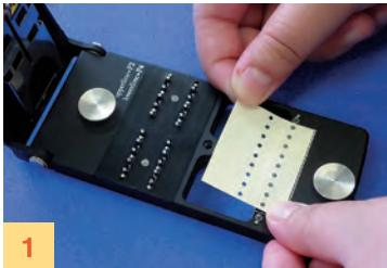
スプライステープの剥離紙をめくらずにスプライス部にセットする。(折り返し破線部を向こう側にしひんに軽く望ませる)
