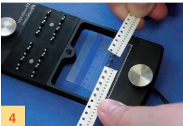
スプライステープの剥離紙をめくり、キャリアテープの切断部を付き合わせ押える。
