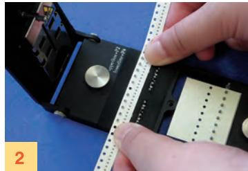
機械側キャリアテープをピッチに合ったカッタ一部のレーンにセットする。(左側に余白が来るよう)
