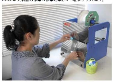
手作業による袋詰めの中でも骨の折れる作業である「袋の開封」 を自動化することで作業者の身体的負担も軽減し、高効率で安定 的な袋詰め作業を実現します。
