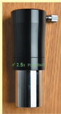
機材③ 撮像システムはもう1系統用意。左: ZWOのPCカメラASI224MC、右:テ レビュー 2.5×パワーメイト。 ※撮像時の拡大率は、PCカメラのピク セルサイズ[μm]×7~9を目安にして みてください。例えば3.75[μm]/ピク セルのカメラの場合、26.25~33.75 になるので、合成FがF25~F35の範 囲になるように拡大率を調整します。
