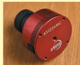
機材③ 撮像システムはもう1系統用意。左: ZWOのPCカメラASI224MC、右:テ レビュー 2.5×パワーメイト。 ※撮像時の拡大率は、PCカメラのピク セルサイズ[μm]×7~9を目安にして みてください。例えば3.75[μm]/ピク セルのカメラの場合、26.25~33.75 になるので、合成FがF25~F35の範 囲になるように拡大率を調整します。
