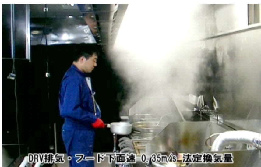
「写真—5 従来型排気(法定換気量)蒸気漏れ状況」
